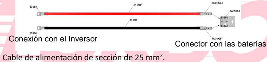
**NOTA:** Cada cable de alimentación puede transportar un máximo de 100 A, por lo que cada dos baterías se necesitaría conectar un nuevo cable al inversor, no obstante, si el inversor es de 5 kW no con un cable sería suficiente al estar en el límite de la corriente máxima recomendada.
